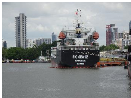
ภาพที่ 2-3 การล้อมท่อน (Boom) รอบลำเรือบรรทุก
