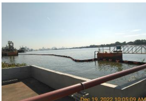
ภาพที่ 2-3 การล้อมท่อน (Boom) รอบลำเรือบรรทุก
